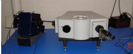
Système préparatoire à la mesure d'une fonction de transfert de monochromateur.
